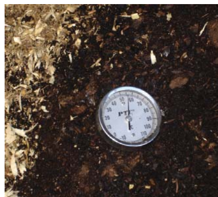
Thermomètre avec une sonde de 3 pieds dans la pile à composter. La température dépasse les 55 degrés Celsius.
