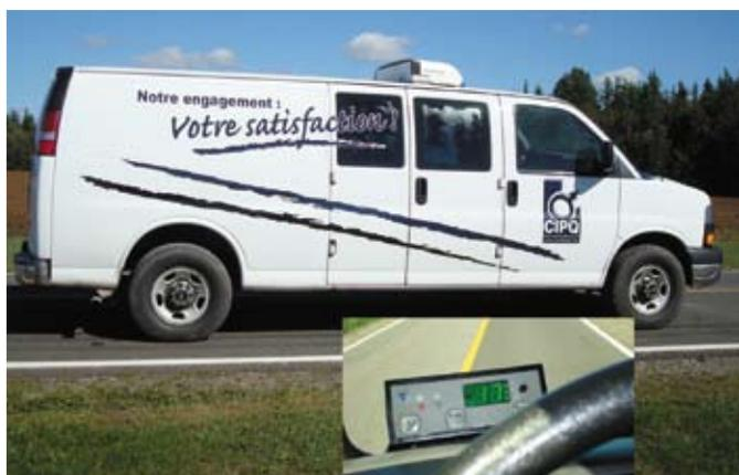
La transport entre les centres est assuré par des véhicules réfrigérés munis d'un affichage dans la cabine du conducteur.
